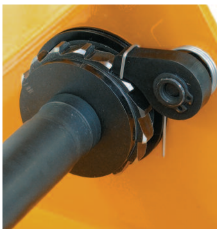
Le frein automatique à cliquet avec ressort inox est le plus éprouvé pour ce type de treuil.
