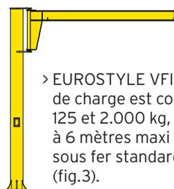
> EUROSTYLE VFI dont la capacité de charge est comprise entre 125 et 2.000 kg, la portée de 2 à 6 mètres maxi et la hauteur sous fer standard est de 3 mètres (fig.3).
