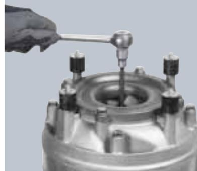
Vis de réglage unique : Le réglage rapide et simple de la turbine permet de rétablir les jeux de fonctionnement quasiment à leurs valeurs initiales et de conserver le rendement de la pompe.
