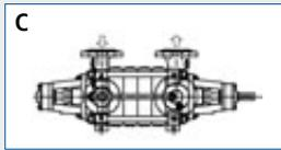
Exécution horizontale sur châssis avec brides radiales, paliers à roulement de chaque côté, entraînement côté refoulement
