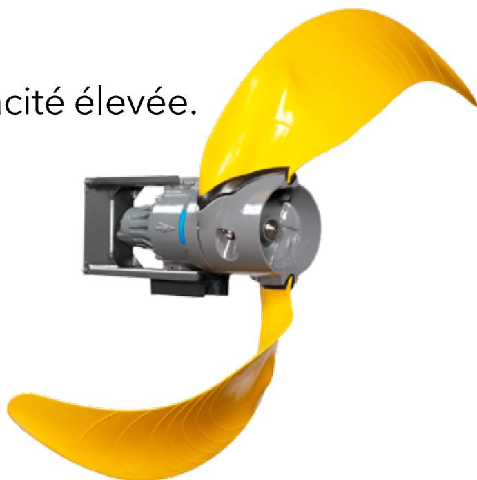
conçu pour fournir une fiabilité et une durabilité élevées. Les bobinages du stator à triple imprégnation de résine sont conformes à la classe H 180°C (355°F) afin de fournir une excellente résistance à l'échauffement et une durée de fonctionnement exceptionnellement longue.
